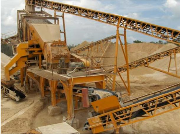
**Figura 2.12** Trituración secundaria y lavado de material
